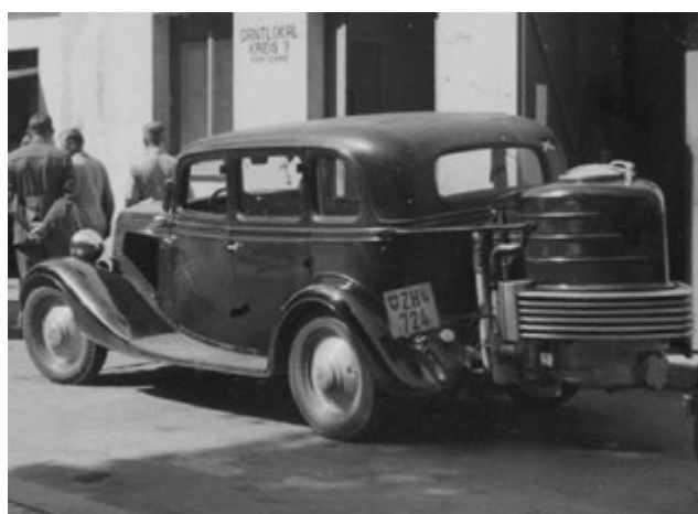
Holzvergaser mit Waibel-Filteranlage, ca. 1942
