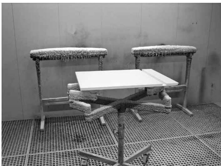
Der Spritzraum mit Spezialbelüftung, damit kein Stäubchen auf die frisch lackierte Fläche fällt. Foto SST
